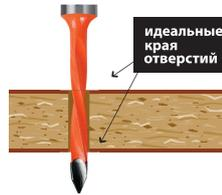
*Коронка сверла изготовлена из мелкозернистого твердого сплава, имеет улучшенную форму заточки для исключительно качественного сверления отверстий при увеличенной подачи*
