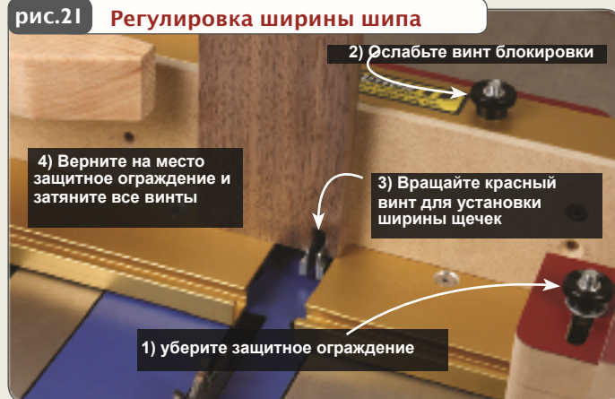
рис.21 Регулировка ширины шипа
